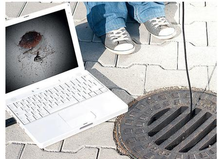
Mittels Aufschraub- Umlenkspiegel und Aufsteck- Magnet können Sie das Endoskop steuern und die Bilder über die Kamera am Computer oder Smartphone anzeigen.
